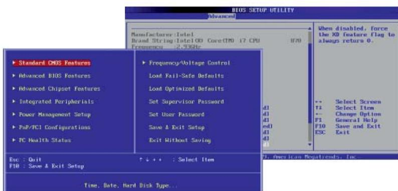
Eine x86-kompatible Computerhardware benötigt ein BIOS (Basis Input/Output System) oder neuer ein UEFI (Unified Extensible Firmware Interface). Diese sogenannte Firmware macht die Hardware funktionsbereit und startet das Betriebssystem. Über das BIOS werden unter anderem viele Hardware-Funktionen aktiviert und konfiguriert. Üblicherweise übernehmen wir die vom Board-Hersteller per Default im UEFI-BIOS vorgegebenen Einstellungen, nehmen aber auch kundenspezifische Anpassungen vor.
