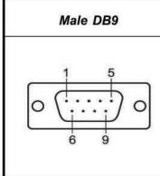
RS422 Pin RS232 RS485-2W RS485-4W DCD 1 TxD+ 2 RxD TxD-3 TxD RxD-Data-4 DTR RxD+ Data+ 5 GND GND GND 6 DSR 7 RTS --8 CTS 202 5030 9
